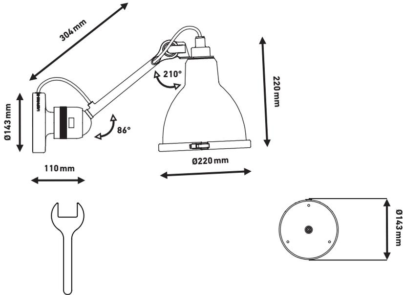
Pour durcir le mouvement serrez la bague de serrage /
